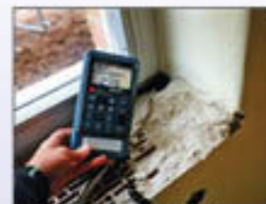
Prüfung mit dem Anemometer
