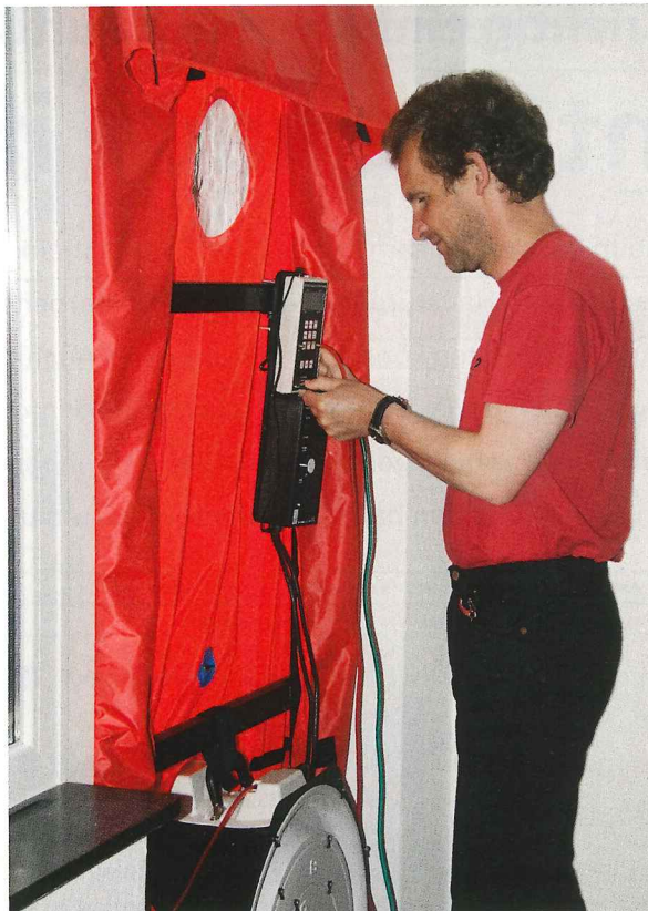
Die EnEV 2014 schreibt für Luftdurchlässigkeitsmessungen Verfahren B der DIN EN 13829 vor.
